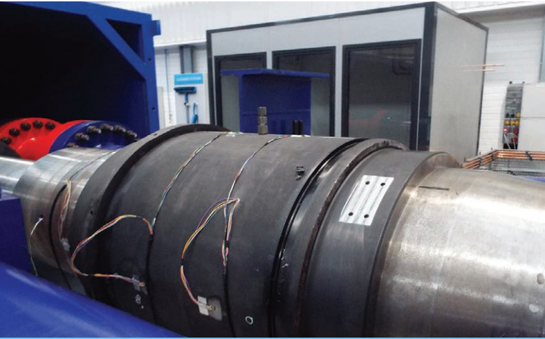
15K HPNI Riser Test
